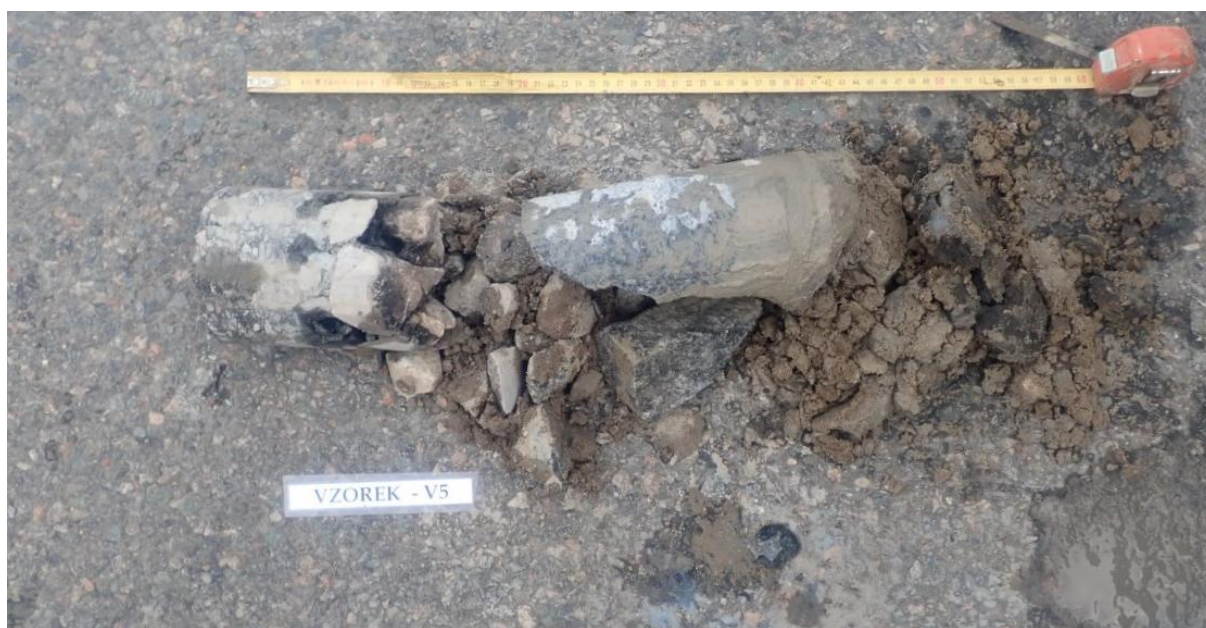
Obr. 9 - Jádro vývrtu Vzorek – V5 (in situ).
