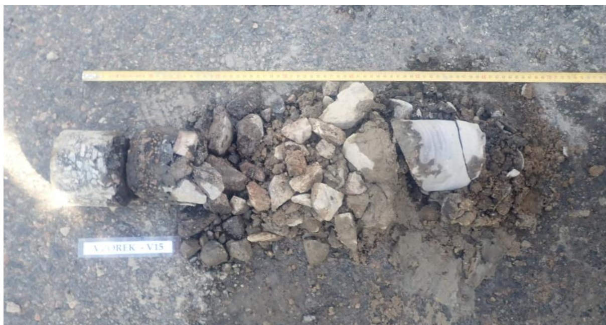
Obr. 29 - Jádro vývrtu Vzorek – V15 (in situ).
