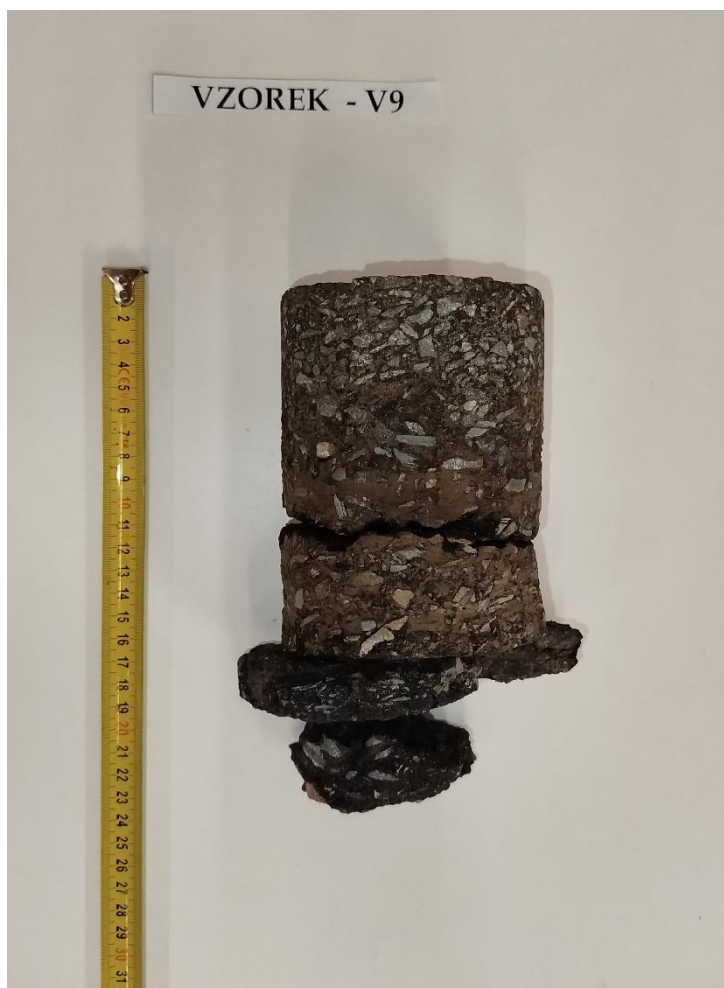
Obr. 18 - Jádro vývrtu Vzorek – V9 (laboratoř).
