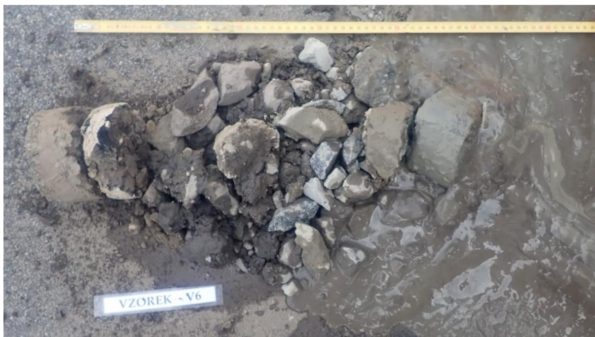
Obr. 11 - Jádro vývrtu Vzorek – V6 (in situ).
