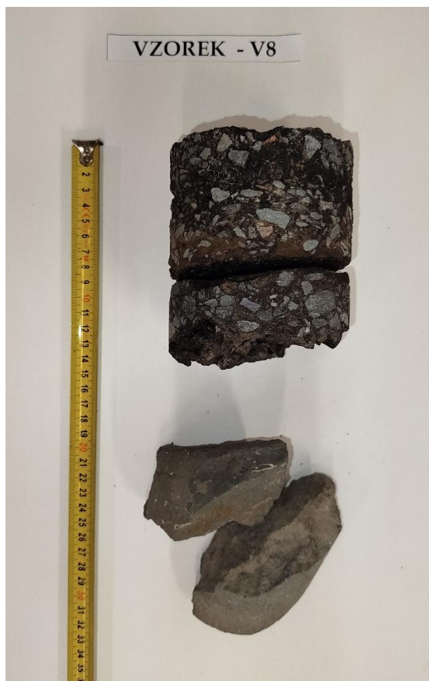
Obr. 16 - Jádru vývrtu Vzorek – V8 (laboratoř).
