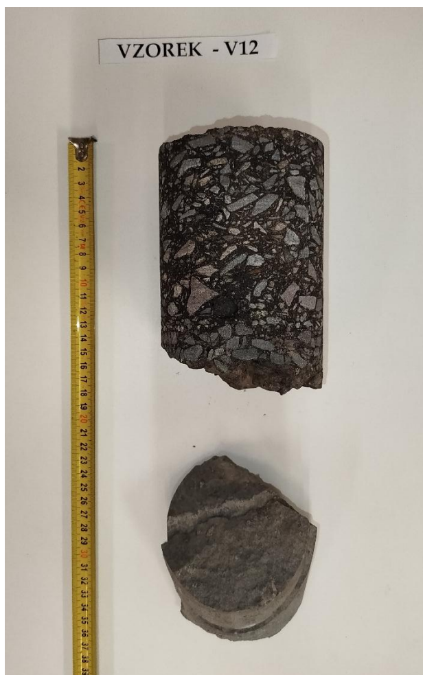
Obr. 24 - Jádru vývrtu Vzorek – V12 (laboratoř).
