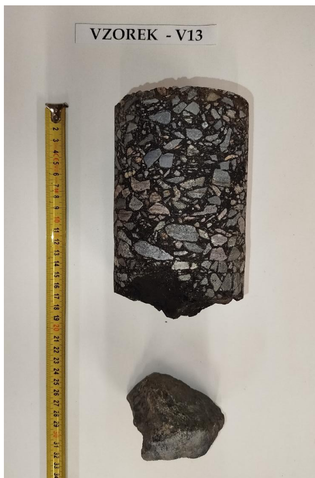
Obr. 26 - Jádru vývrtu Vzorek – V13 (laboratoř).
