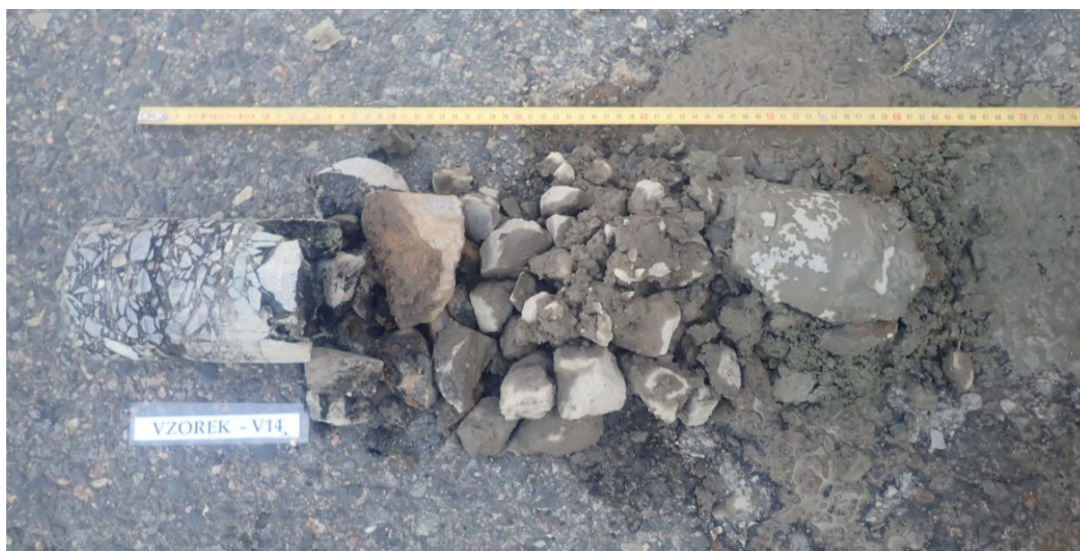
Obr. 27 - Jádro vývrtu Vzorek – V14 (in situ).
