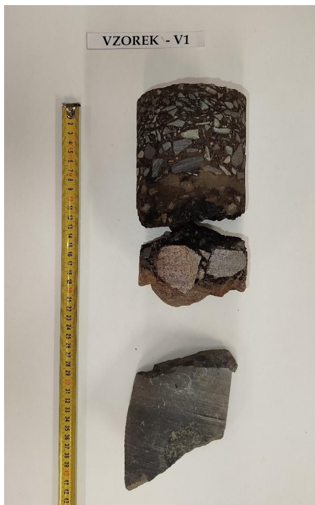
Obr. 2 - Jádru vývrtu Vzorek – V1 (laboratoř).
