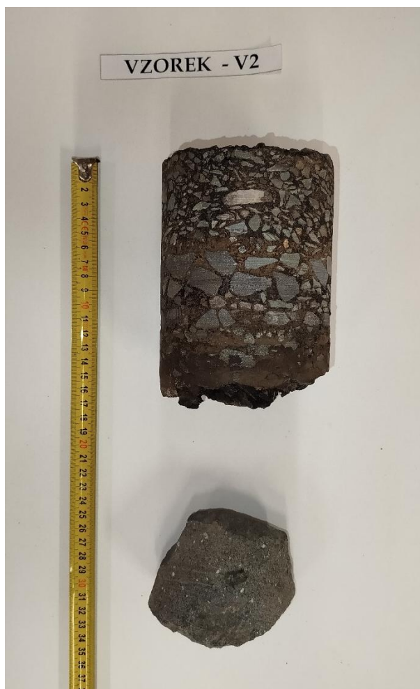
Obr. 4 - Jádru vývrtu Vzorek – V2 (laboratoř).
