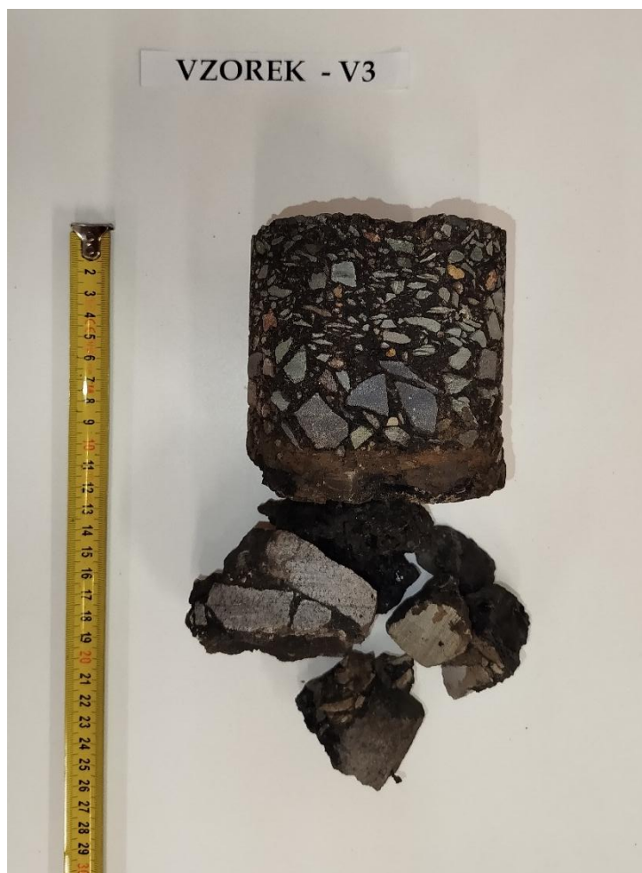
Obr. 6 - Jádru vývrtu Vzorek – V3 (laboratoř).
