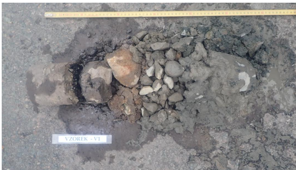
Obr. 1 - Jádro vývrtu Vzorek – V1 (in situ).
