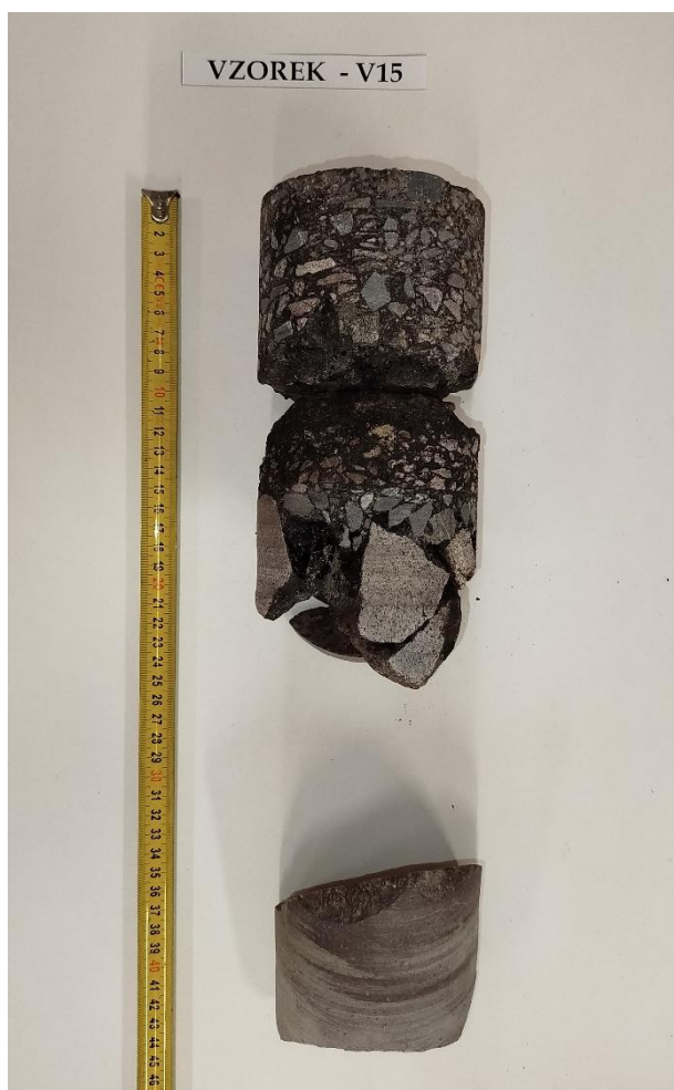
Obr. 30 - Jádru vývrtu Vzorek – V15 (laboratoř).
