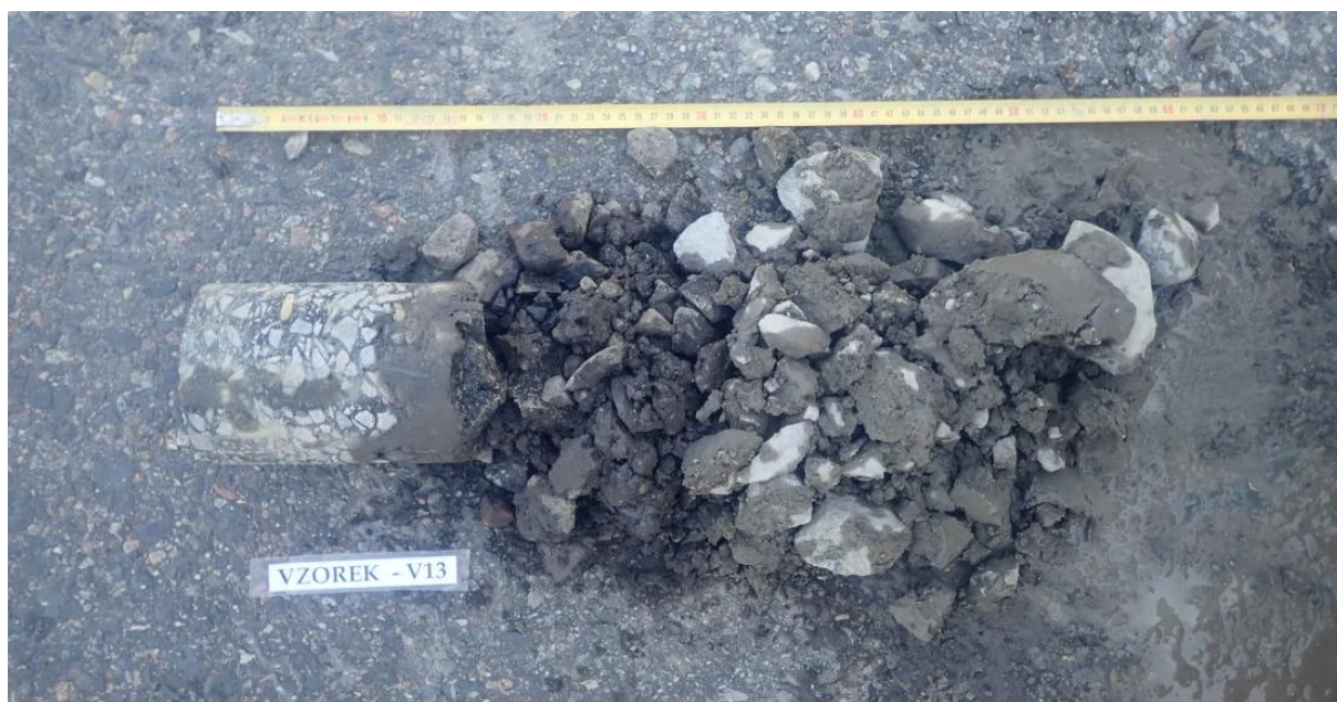
Obr. 25 - Jádro vývrtu Vzorek – V13 (in situ).
