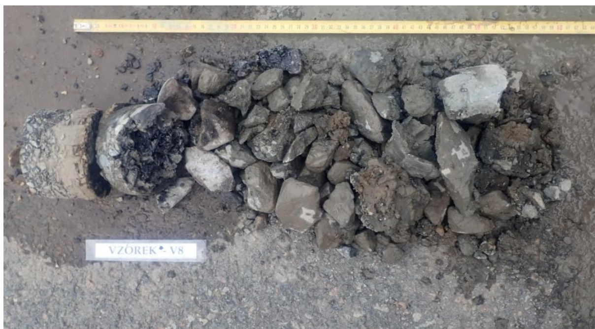
Obr. 15 - Jádru vývrtu Vzorek – V8 (in situ).
