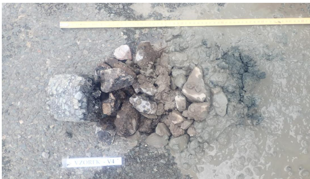
Obr. 7 - Jádro výtvtu Vzorek – V4 (in situ).
