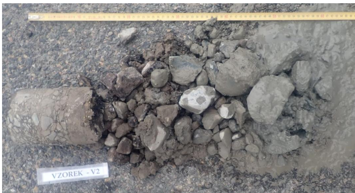
Obr. 3 - Jádro vývrtu Vzorek – V2 (in situ).
