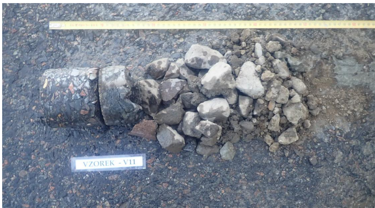
Obr. 21 - Jádro vývrtu Vzorek – V11 (in situ).
